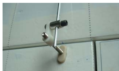
4E - Install aileron control horn
